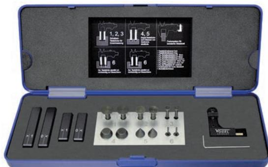
Sistema di controllo della forza di misurazione
